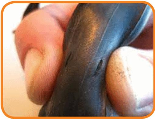
Pressioni troppo basse del pneumatico possono portare a rovinare il cerchio in caso si superi un ostacolo “spigoloso” o causare pizzicature della camera d’aria quando i fianchi del cerchio comprimono la gomma; questo tipo di foratura viene chiamato anche “snake bite” (trd. morso di serpente) a causa dei suoi due tipici segni paralleli.
