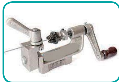
il filetto rullato ha diametro maggiore del corpo raggio
