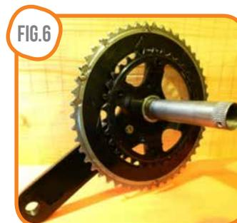
Nella guarnitura **Ultra Torque** l'asse di movimento centrale è suddiviso in due parti solidali con ciascuna pedivella, alle estremità si trovano due superfici ad ingranaggi che, una volta montate, combaciano tra loro (FIG.7)
