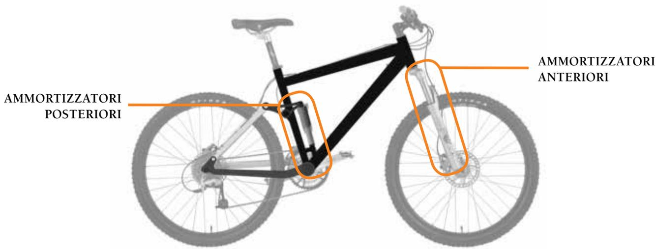
Nelle MTB, come per alcune bici da Trekking, gli ammortizzatori sono diventati di serie: servono ad attutire asperità del terreno (anche importanti) ed a permetterci di stare in sella in modo più sicuro e confortevole.
