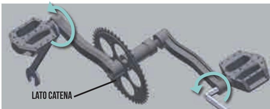
Togliere i pedali svitandoli con apposita chiave a forchetta o brugola, ricordarsi che un pedale ha filettatura destrorsa e l'altro sinistrorsa. Ecco uno schema.
